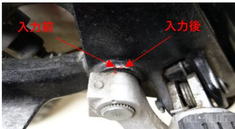
ブレーキペダルピボットにもマーキングを打っています。
