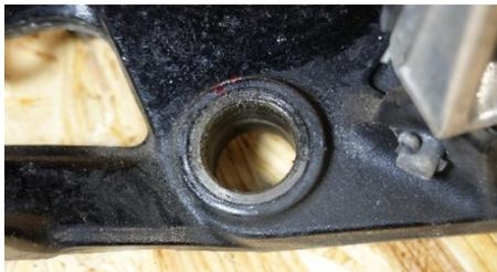
ペダルピボットのグリス切れ、汚れの付着により動きに引っ掛かり有り。
